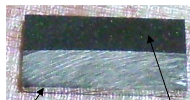
Рисунок 1 Двухслойный материал: а) УН; б) пористый материал
