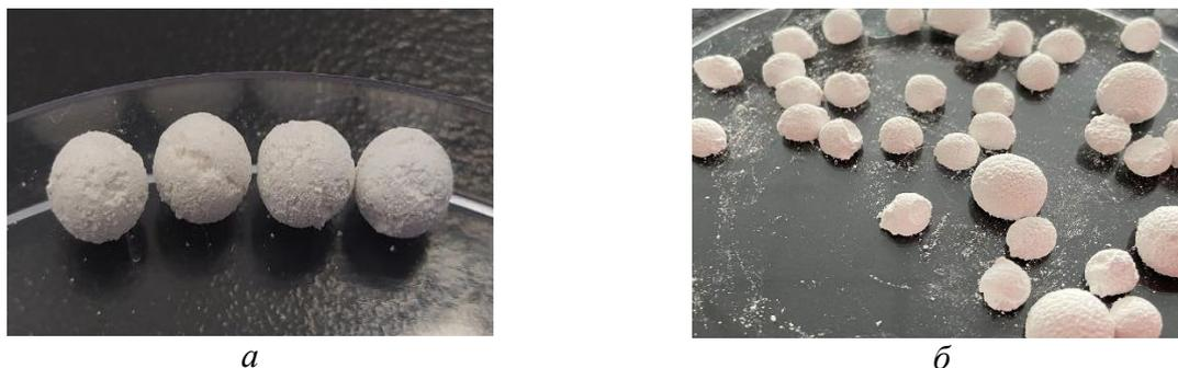
Рис. 1. Фотографии образцов: *а* – ГА/ВТ 100/0 1.1 г/мл 2.5% хитозана, *б* – ГА/ВТ 20/80 0.9 г/мл 1.5% хитозана
